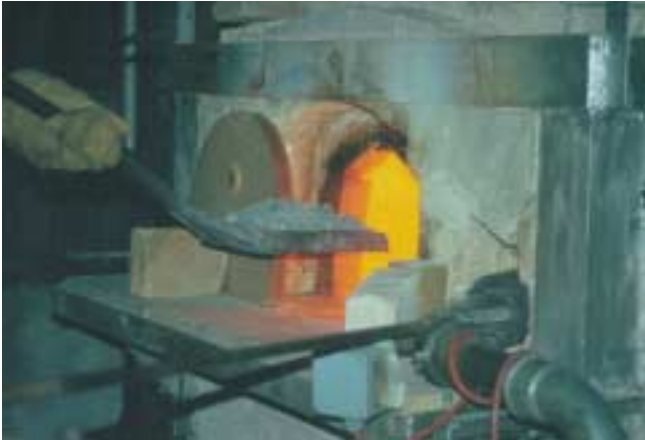
8 Einlegen der Granalien in den Hafen-Ofen 8 Charging of the granules into the pot furnace
