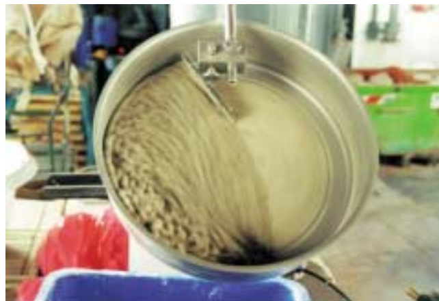
5 Laborgranulierteller mit einem Durchmesser von 0,5 m 5 Laboratory dish granulator, diameter 0.5 m
