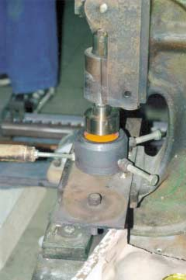
11 Pressen von Plaketten 11 Pressing of coupons
