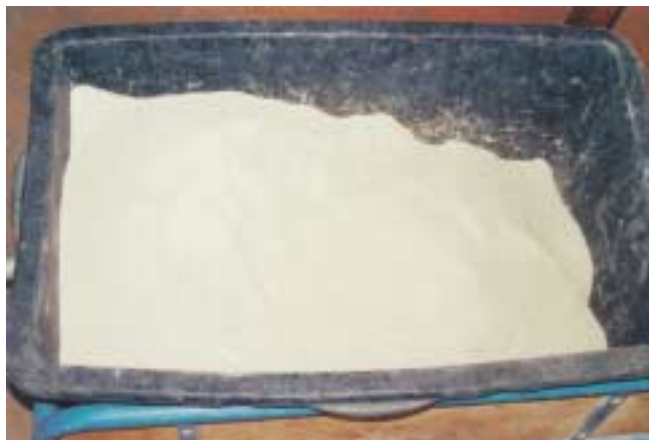
4 Feinpulveriges, homogenisiertes Glasgemenge 4 Fine-particled, homogenized glass-making batch
