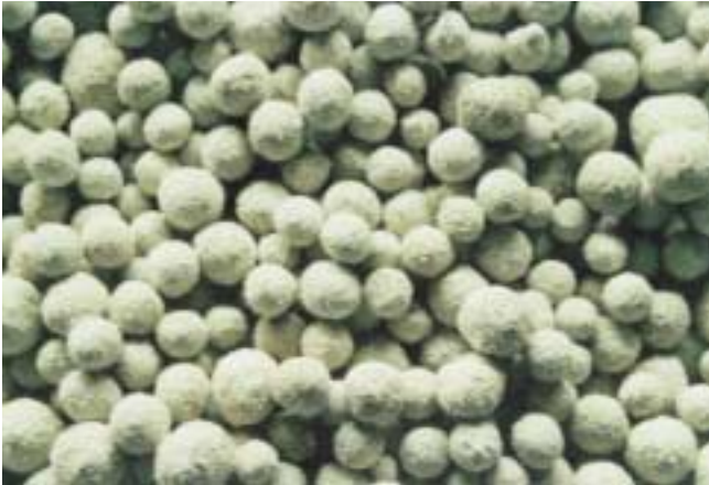
6 Granalien definierter Zielgröße 6 Granules of a defined target size
